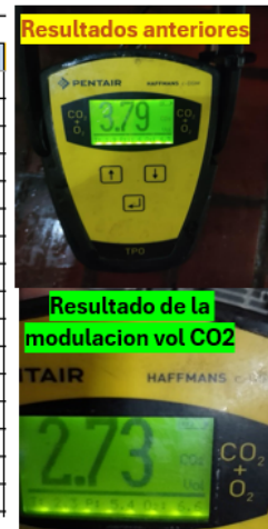
Figura 66. Bitácora de control de contenido de CO 2 para la filtración de cerveza.
